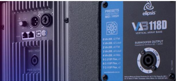
El subwoofer VAB-118D incorpora un procesador interno que cuenta con 8 presets diferentes, los cuales facilitan al usuario el uso del sistema, permitiéndole seleccionar el mas adecuado en base a sus necesidades ó al tipo de sistema.
