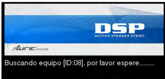
En la siguiente pantalla se mostrara una lista con los equipos conectados, se puede observar en cada región un ID diferente. De esta manera se puede identificar cada uno de los equipos. Para editar el DSP de una unidad específica, de doble click sobre el equipo con el puntero del mouse.
