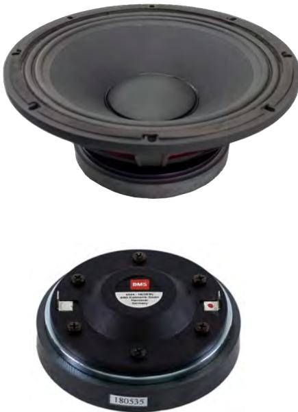
Hemos incorporado dos drivers BMS 4544 que nos permite mucho mas presencia en el rango de las voces y nos permite tiros mas largos sin perder la componente del medio agudo. La impedancia de ambos drivers es de  $16 \Omega + 16 \Omega$  en paralelo para un total de  $8 \Omega$ , asegurando un amplificador frio capaces de manejar hasta 100 Wrms.
