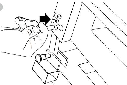
La manera de sujetar las unidades al bumper-dolly transportador es exactamente la misma utilizada para unir una unidad contra la otra. Se alinean las piezas en la posición deseada y se introduce el perno manteniendo presionado el accionador de bolas.
