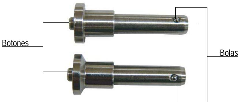
Al oprimir el botón al extremo de los pernos, la tensión se relaja permitiendo a las bolas ocultarse bajo la superficie del perno, lo que permite introducir dicho perno en los orificios del sistema de rigging. Cuando se deja de oprimir el botón, las bolas quedan firmes sobre la superficie del perno impidiendo que el perno se salga del orificio.
