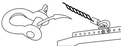
2.- Sujetar el primer baffle al bumper mediante los pernos de seguridad como se ha visto anteriormente.
