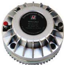
La impedancia del driver es de  $16\Omega$ , y es capaz de manejar hasta 60W rms si el corte de frecuencia se realiza con filtro pasa altas de cualquier tipo a 24dB por arriba de 1.8kHz. Su magneto de neodimio lo hace realmente ligero, contribuyendo al bajo peso de la unidad
