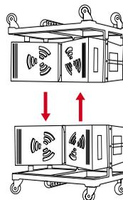
También es posible ensamblar varios gabinetes en tierra (uno sobre otro), colocar el bumper sobre el baffle superior y posteriormente realizar la elevación.
