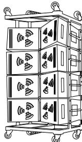
El bumper funciona también como dolly o carro transportador. De la misma manera es usado como base de un sistema estacado, es decir, trabajando a compresión.
