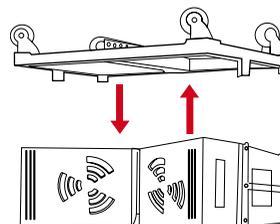
3.- De la misma manera, subir un poco el gancho de elevación para dar cabida al siguiente baffle, y así sucesivamente hasta ensamblar el último de la columna.
